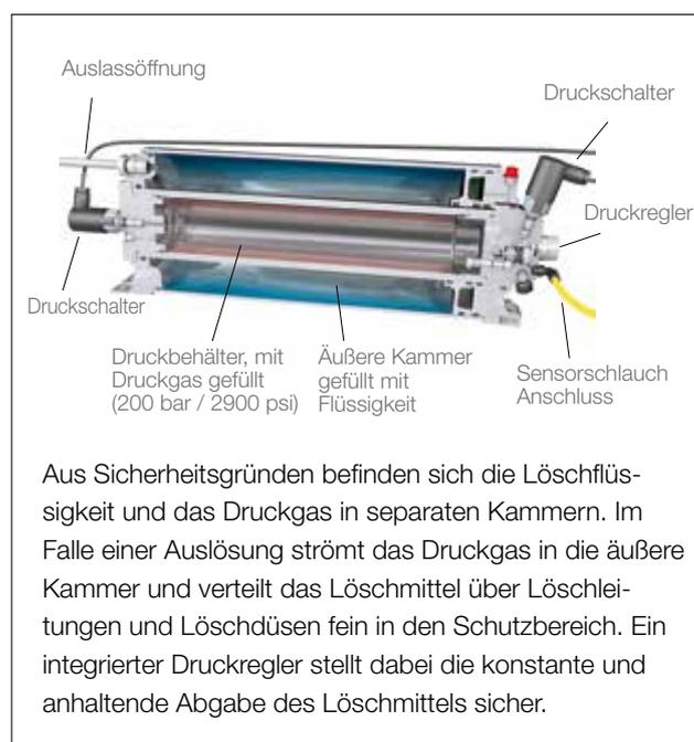
Aus Sicherheitsgründen befinden sich die Löschlöslichkeit und das Druckgas in separaten Kammern. Im Falle einer Auslösung strömt das Druckgas in die äußere Kammer und verteilt das Löschmittel über Löschleitungen und Löschdüsen fein in den Schutzbereich. Ein integrierter Druckregler stellt dabei die konstante und anhaltende Abgabe des Löschmittels sicher.
